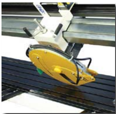
BRIDGE TILT AT 45 DEGREES ► Inclinazione ponte a 45°
