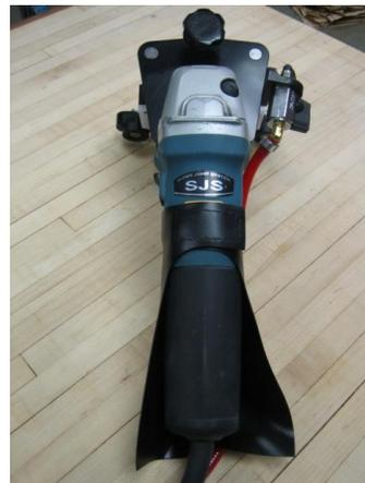
**FIGURA 7 – Instalación del Delantal (Spray)**
