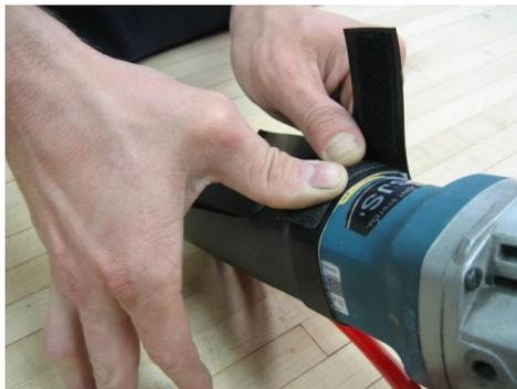
**FIGURA 6 – Instalación del Delantal Atomizador (Spray)**
