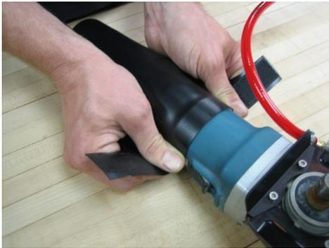
**FIGURA 4 – Instalación del Delantal (Spray)**
